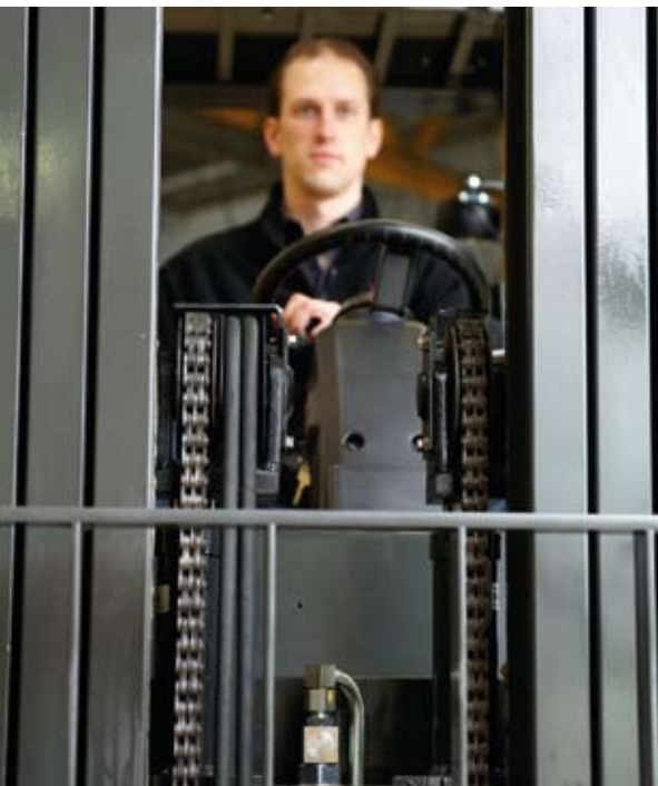
De driedelige Optiview mast met gescheiden cilinders voor de vrije heffing verbetert het zicht op de vorkpunten en rijweg aanzienlijk
